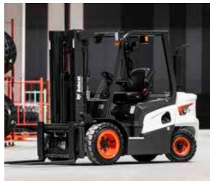
Der Einsatz eines neuen Antriebsstrangs mit U-Gelenken und ölgekühlten Scheibenbremsen sorgt für geringe Vibrationen und einen niedrigen Geräuschpegel von 77 dBA am Ohr des Fahrers.
